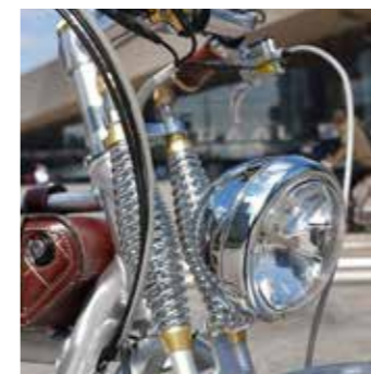
De retro koplamp is voorzien van LED
