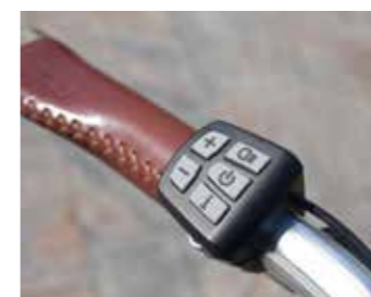
De regelunit voor o.a. de verschillende rijmodi
